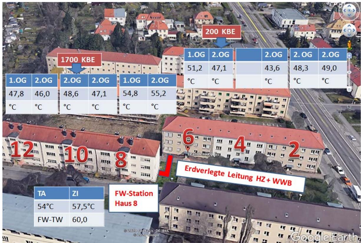
Gemeinsam mit der Wartungsfirma wurden diese Temperaturen im Rahmen einer Ortsbesichtigung einmal mit einem Infrarotthermometer und als alternative mit der Thermografie nachgemessen.
