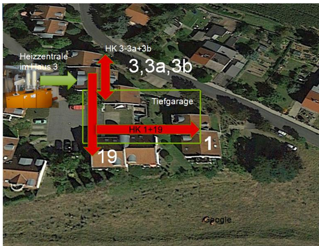
Bild 1 - Lageplan der Wärmeversorgung Mögliche Lösungen
