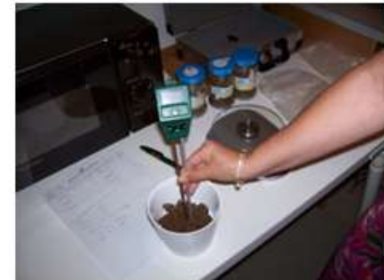
Bild 23: Messungen der Bodenfeuchte mittels Combiter vor der Trocknung als Grobbewertung
