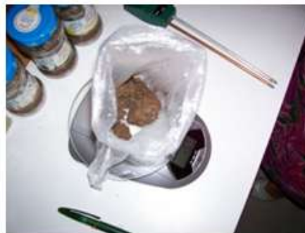
Bild 25: Wägung der Bodenprobe nach der Trocknung
